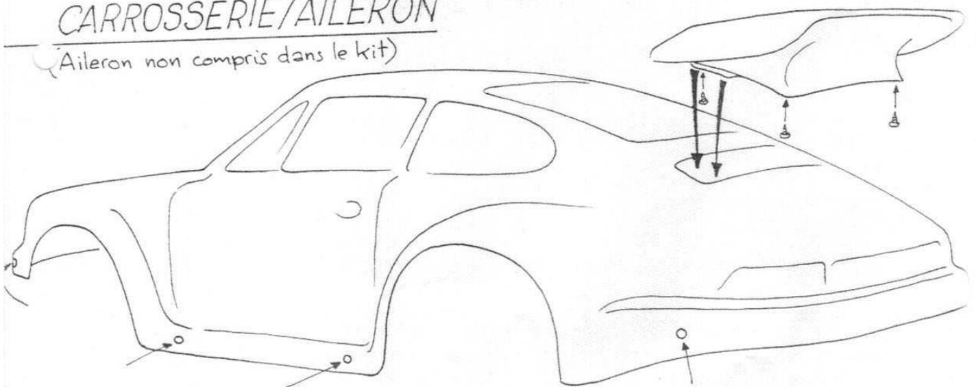
Découper la carrosserie comme indiqué. Fixer l'aileron avec du double-face aux points de contact, puis percer et terminer la fixation par 4 vis. Percer la carrosserie aux emplacements des plots de fixation sur le châssis.
