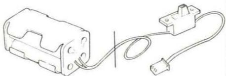
Eine separate Batteriebox wird bei diesem Modell nicht benötigt. Schalter mit Kabel nach Abb. von der Batteriebox trennen.
