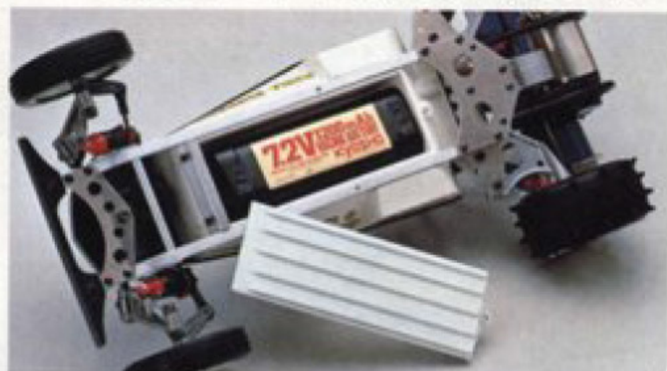
ニカドパックの脱着がワンタッチ、防じん防砂をかねた、ハッチ式モカボックス。フレームは、レースを勝ち抜いてきたLAラダー方式。
