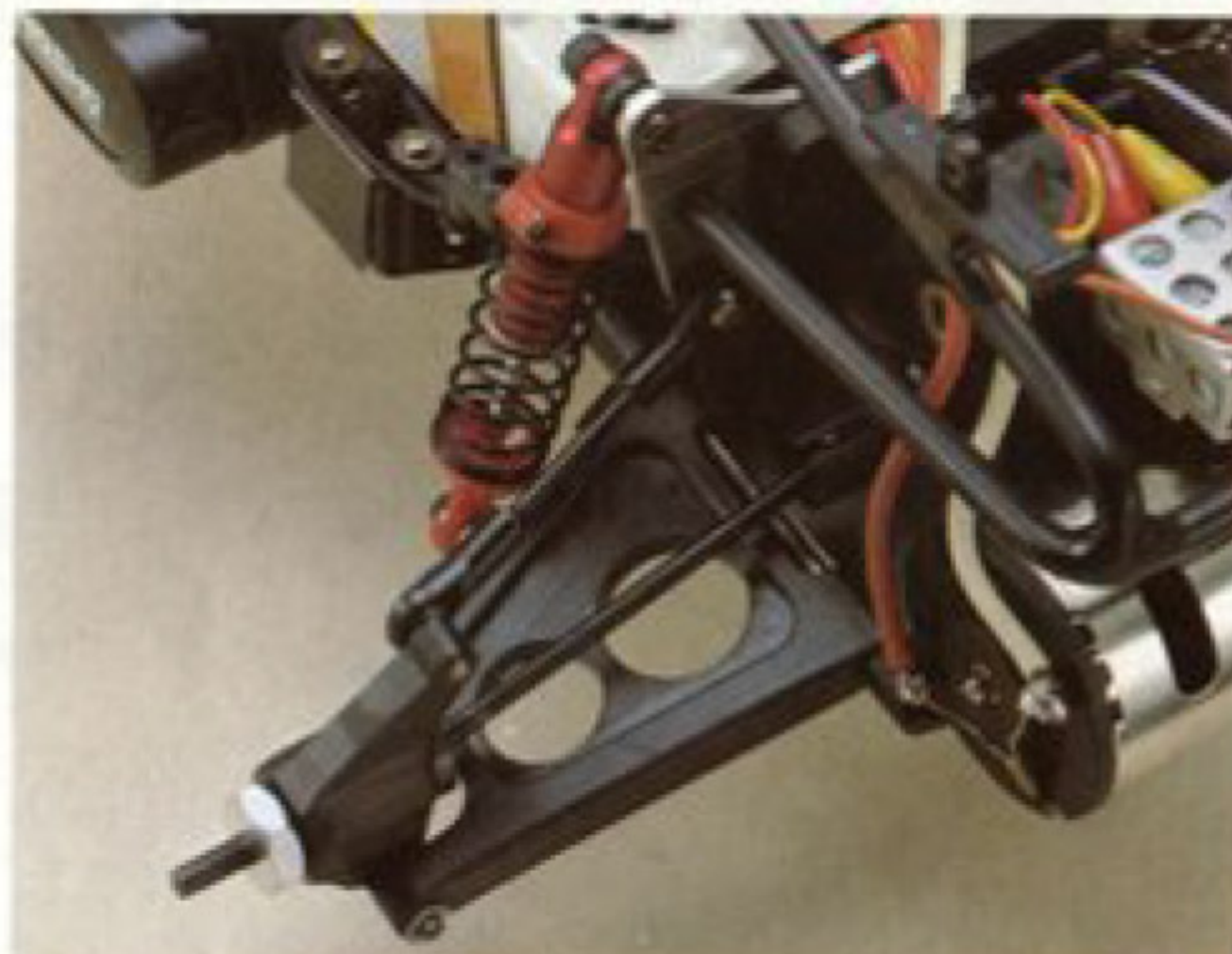
リヤにも実績のWフィッシュボーン形式のサスペンションを採用することにより、路面の変化に対して抜群の追従性を発揮します。
