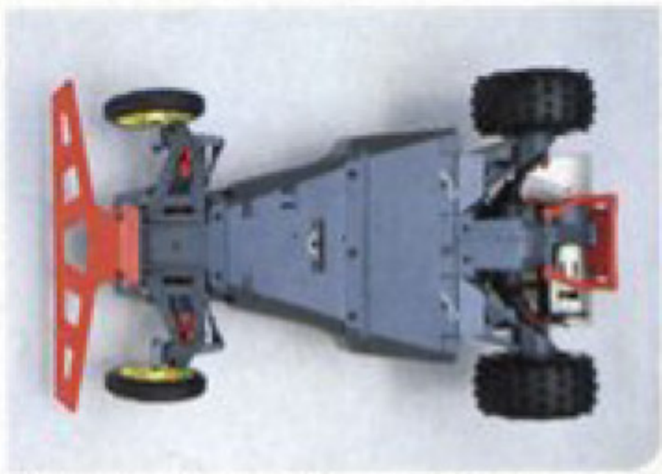
RS540Sモーター標準装備。デフギヤの装備でコーナリングも安定走行。
