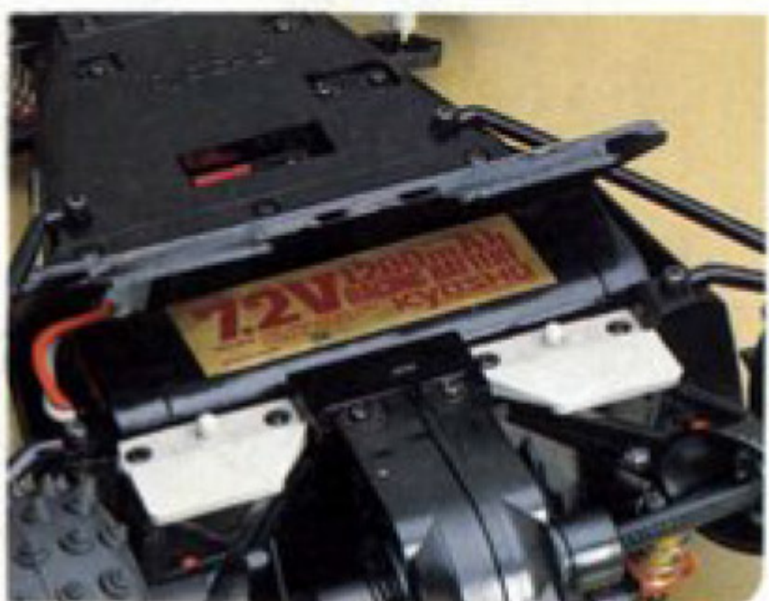
バッテリーの脱着は、シャーシ裏面のハッチから。砂利やドロをシャットアウトするハウジングタイプ。
