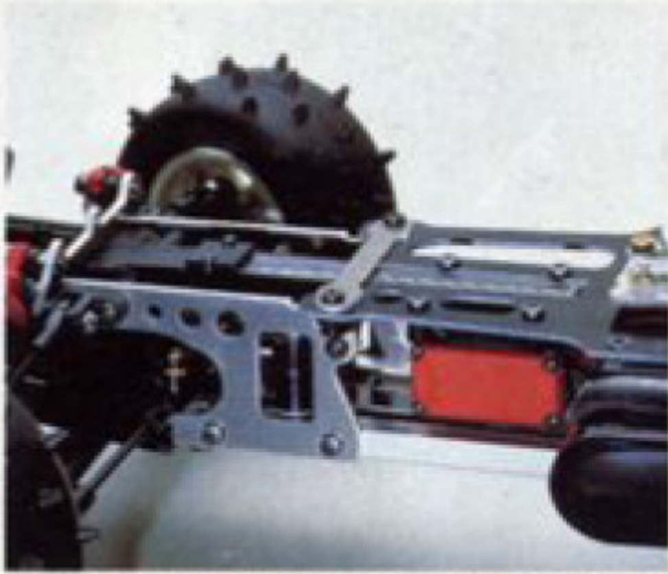
4WDの常識を打ち破る大ステアリング切れ角を実現。コンパートメント4WDチェーン方式でチェーンをフルシールド。トラブルフリーを実現。
