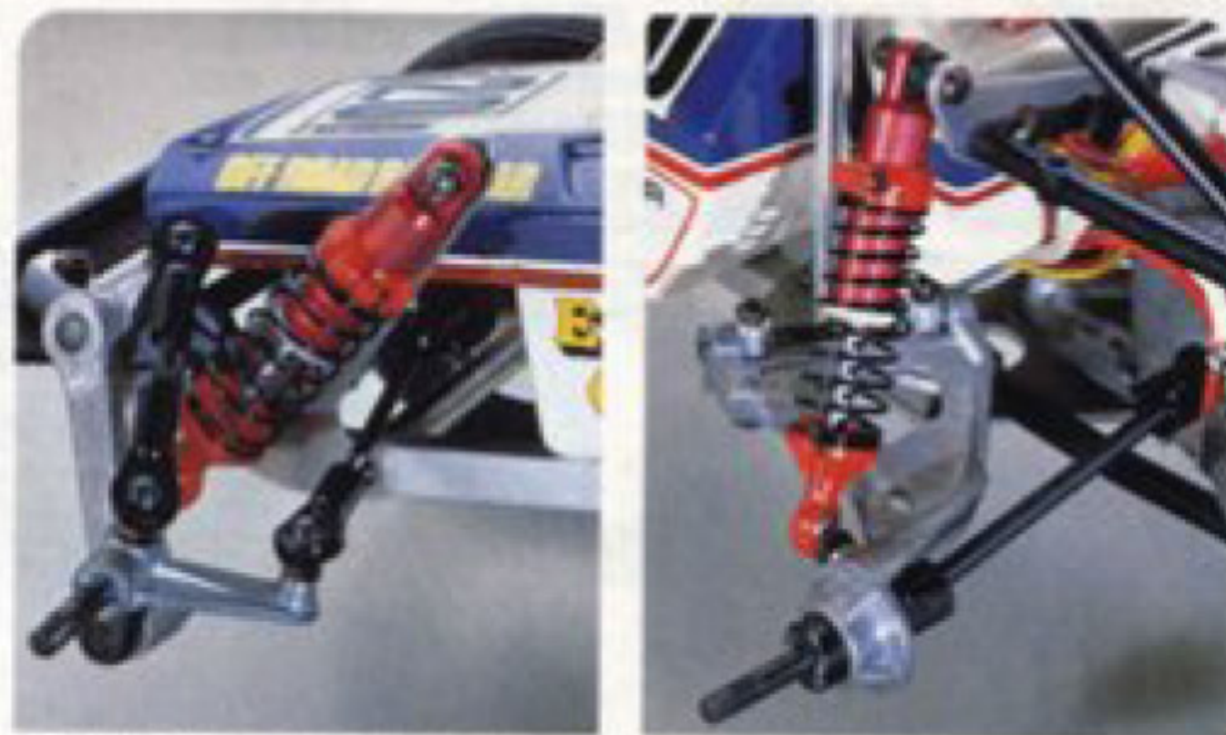
大容量10ミリ径オイルダンパー4基を装備。ボールエンドの強度などにも細心の注意を施した、ベストバランス最重要視のデ・チューン・サス。
