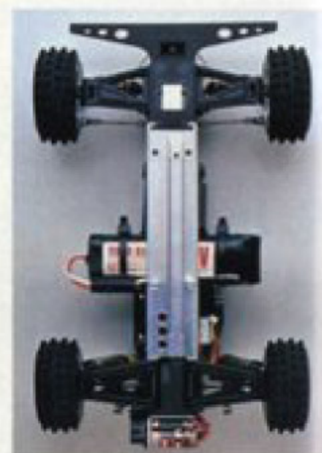
アルミ製のバッグボーン形式シャーシ。シャーシ下部をまもるアンダーガード付。
