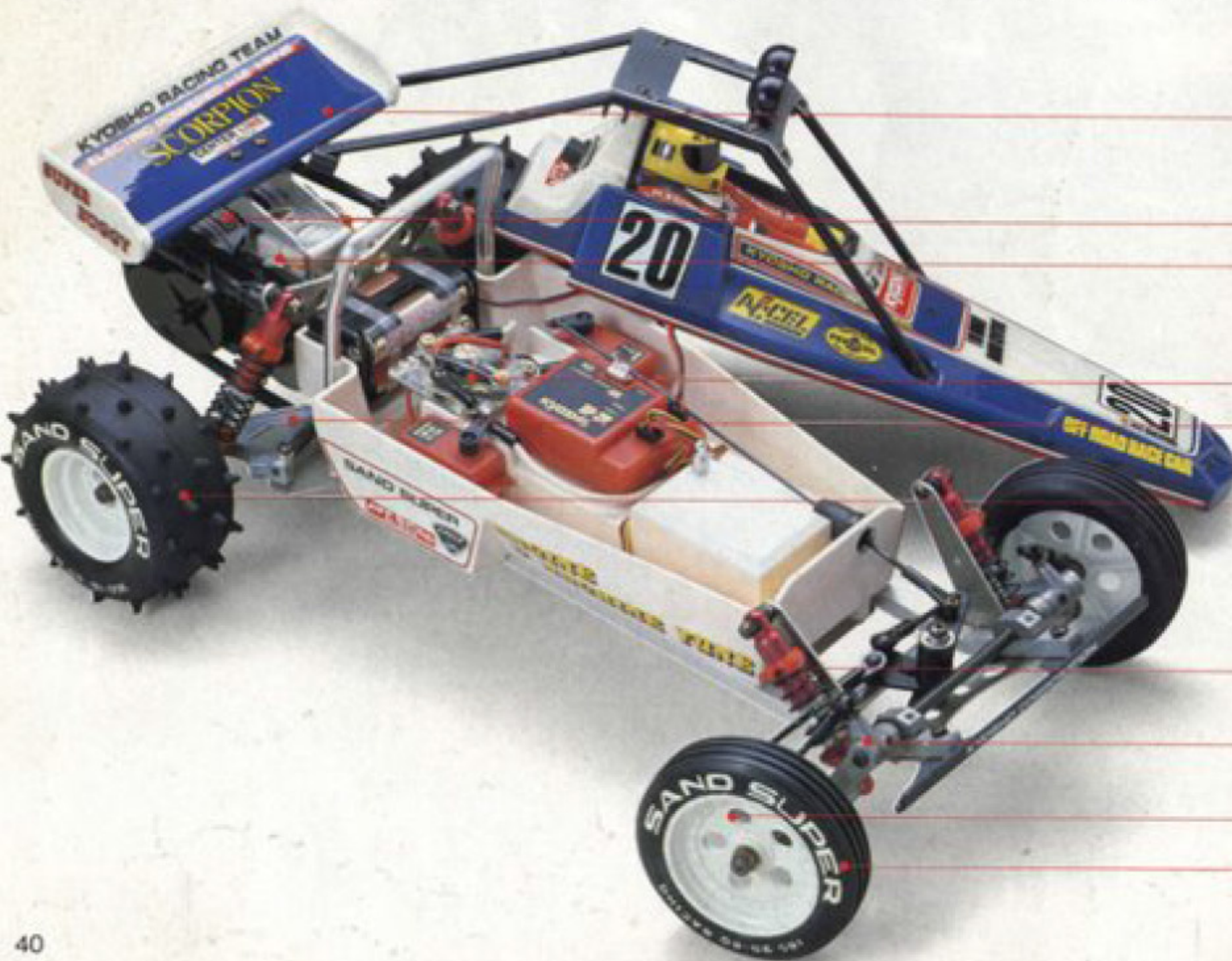
ニカドパックの脱着がワンタッチ、防じん防砂をかねた、ハッチ式モカボックス。フレームは、レースを勝ち抜いてきたLAラダー方式。
