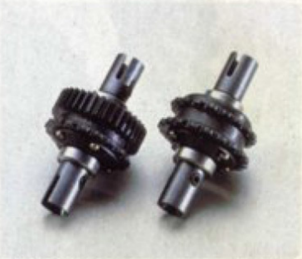
前後2基の超高精度デファレンシャルギヤを標準装備。リヤ18Tのスプロケットに対し、フロントは18T、19Tの2段階からセレクト可能。そのためF18:R18(前後等速)、F19:R18、F18:R19の3種のセットができる。
