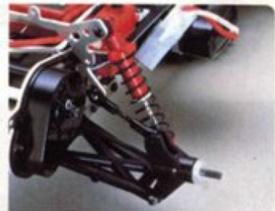
大きなストロークを持つロングウィッシュボーンサス(ダブルタイプ)を前後に採用。リヤ専用大口径オイルダンパー装備。アッパーロッドは3段階の取り付け位置変更ができ、キャンバー角をセッティング可能。
