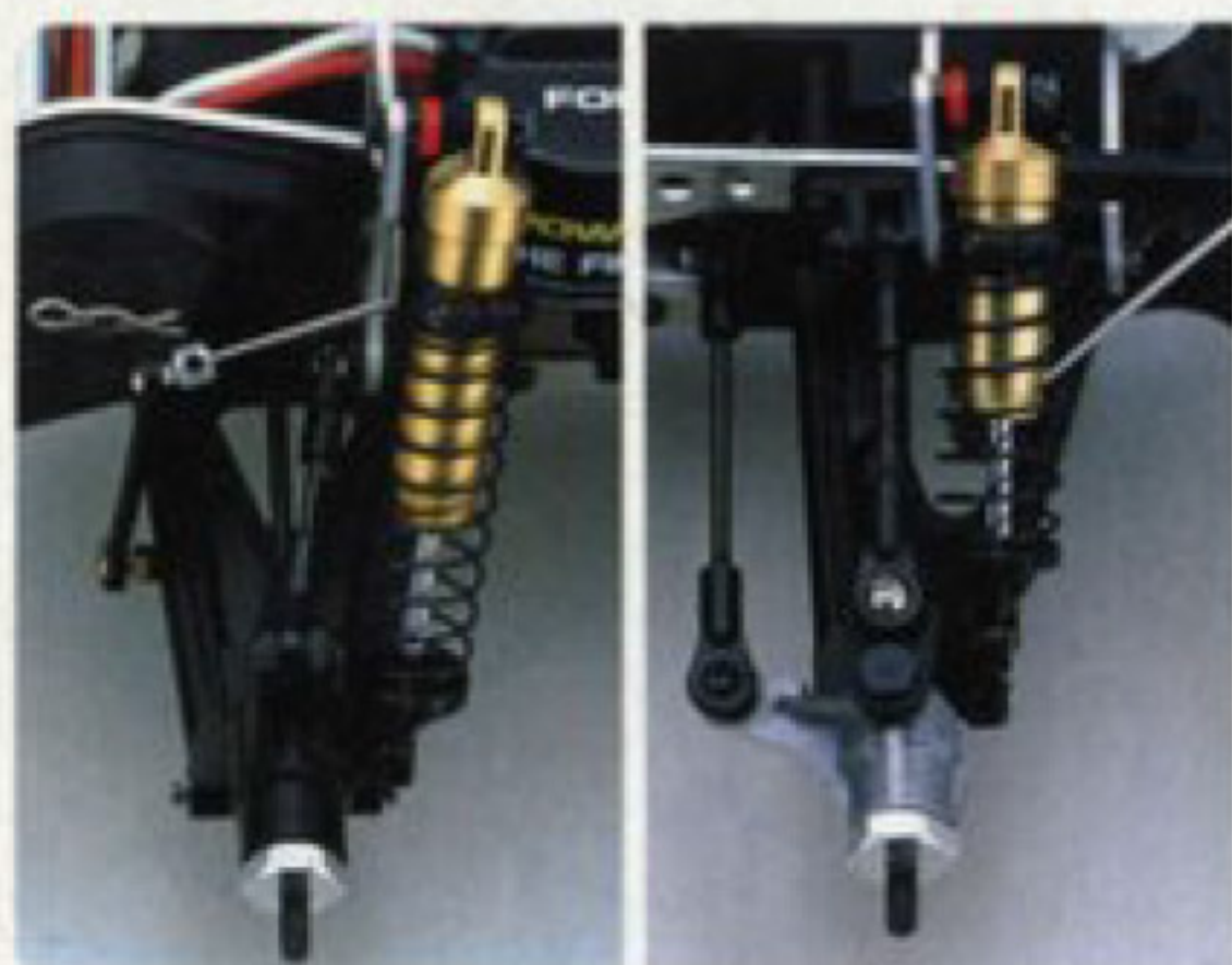
超ロングストロークの鍛え上げたWウィッシュボーン・サスペンションが、過酷な路面にも対応する抜群の走破力を実現。
