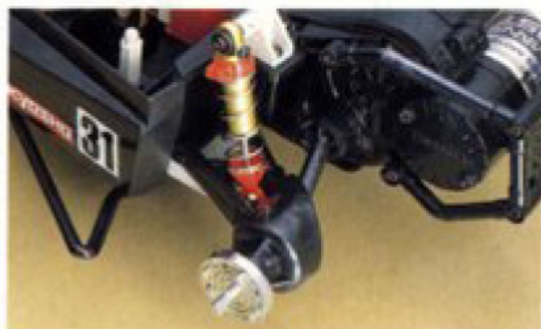
リヤにもオイルダンパーを装備した本格サスペンション。トレーリングアーム方式の完全独立懸架。
