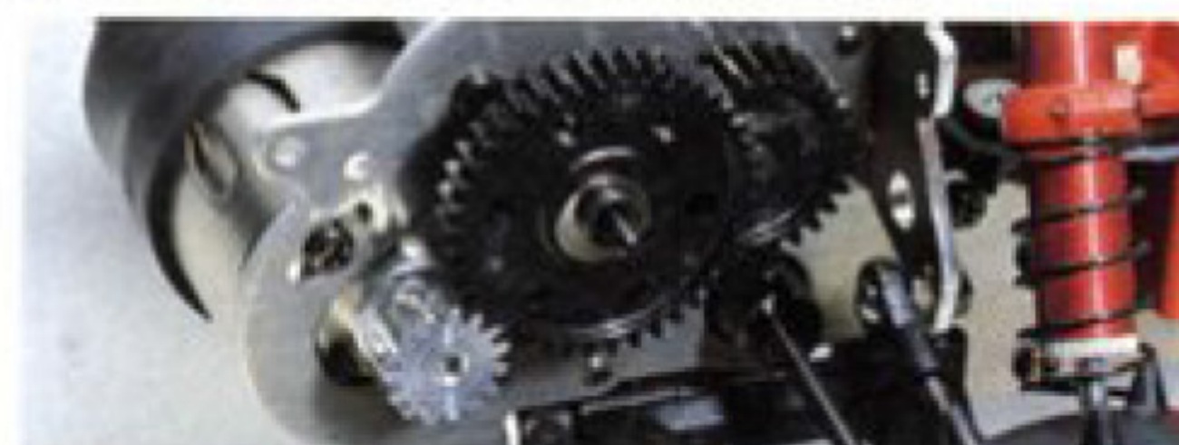
外部と隔離したコンパートメント4WDチェーン方式。
