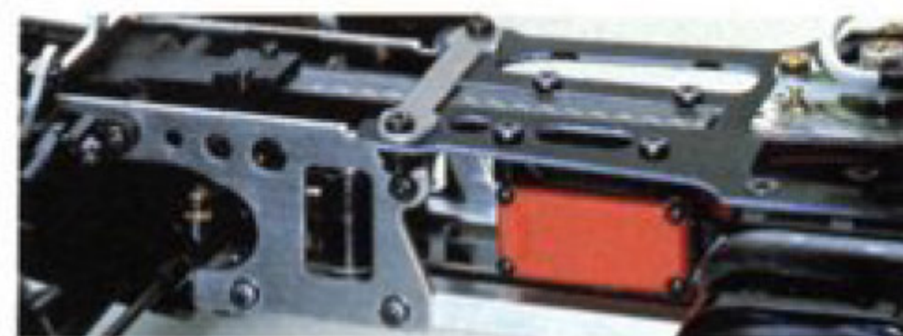
外部と隔離したコンパートメント4WDチェーン方式。
