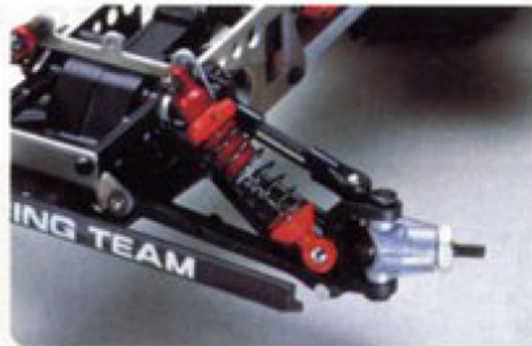
大きなストロークを持つロングウィッシュボーンサス(ダブルタイプ)を前後に採用。リヤ専用大口径オイルダンパー装備。アッパーロッドは3段階の取り付け位置変更ができ、キャンバー角をセッティング可能。
