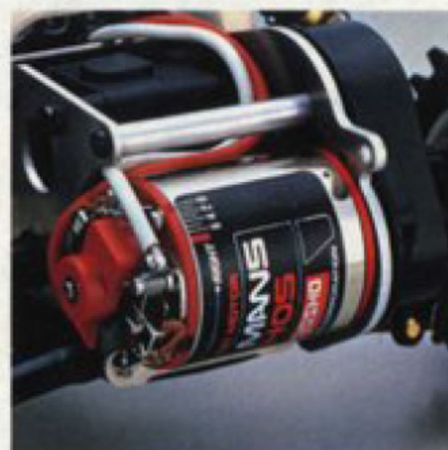
純レーシング高回転タイプのル・マン240Sモーターを搭載。ここぞという勝負時に威力を発揮。
