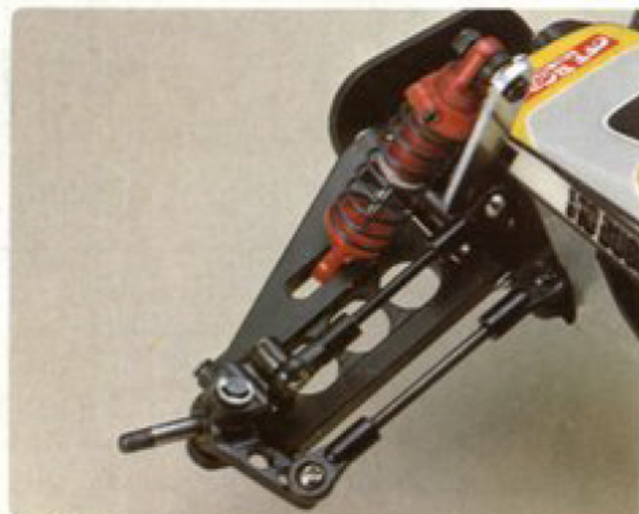
超ロングストロークのWフィッシュボーンを採用。オプティマで高い評価を得た足まわりをさらに熟成し、卓越した走りを実現。
