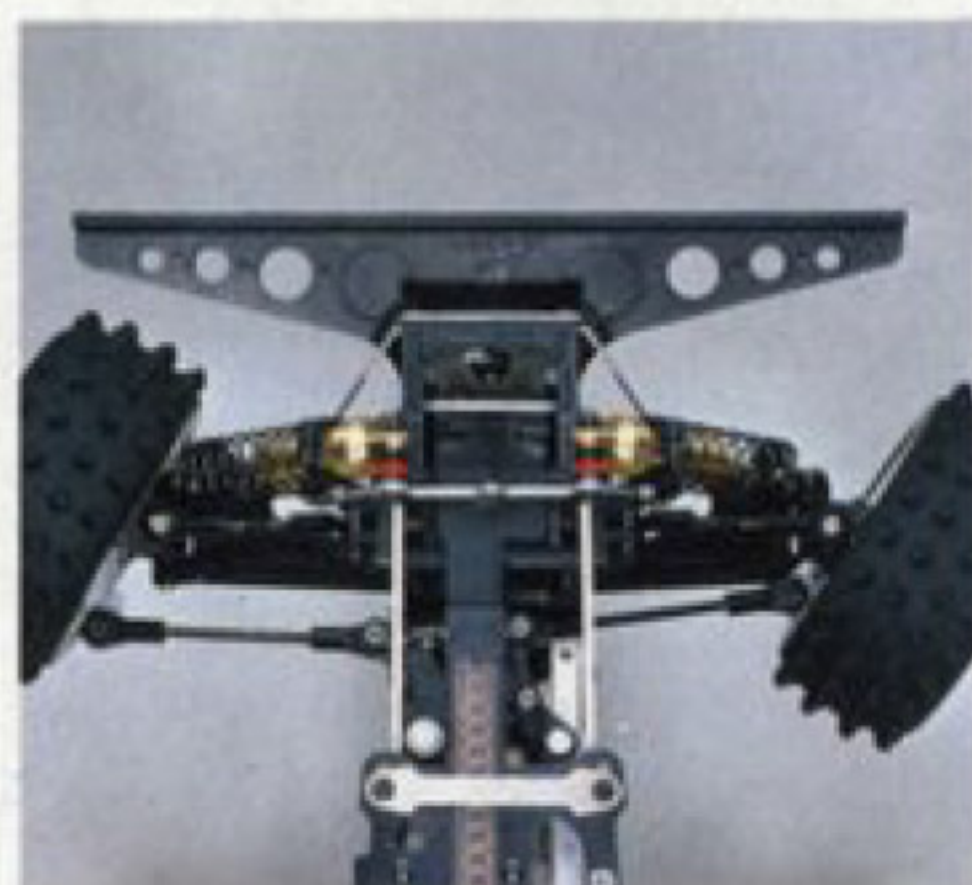
セバレート・リンケージ方式のステアリングシステムにより、鋭角なコーナーも思いのままにクリア。
