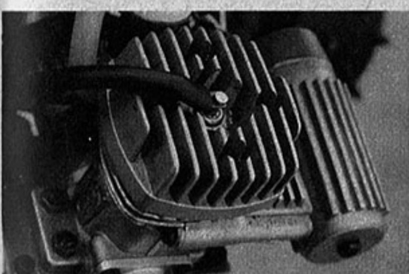
③プラグヘッドにはクリップコードがセットされる。ロック式のプラグヒーターを使用する場合にはこれをはずしておく。ニードル調整は不要だ
