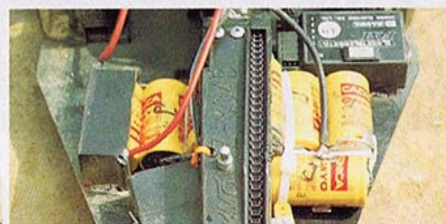
↑ほとんど重心位置においてある…という電池パック ⇨下からみたカーボン・シャーシ
