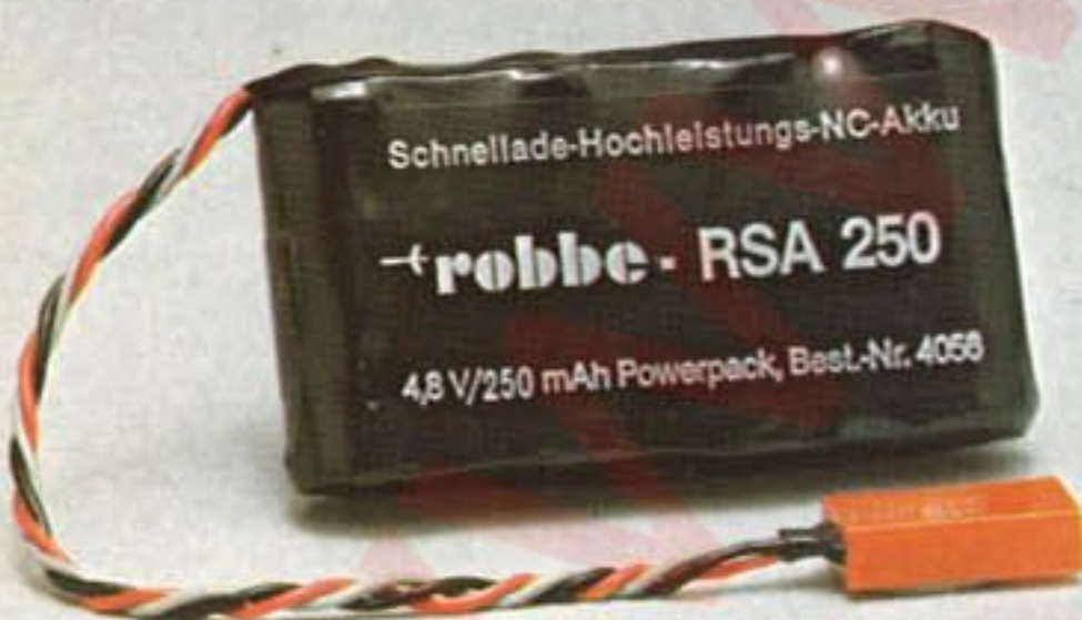
Schnellladefähiger Powerpack 4,8 V/250 mAh Bestell-Nr. 4056 Empfängerakku mit 3-pol-Mini-buchse, flache Bauform, geringe Abmessungen, niedriges Gewicht schnellladefähig Maße 55 x 30 x 15 Gewicht: 86 g
