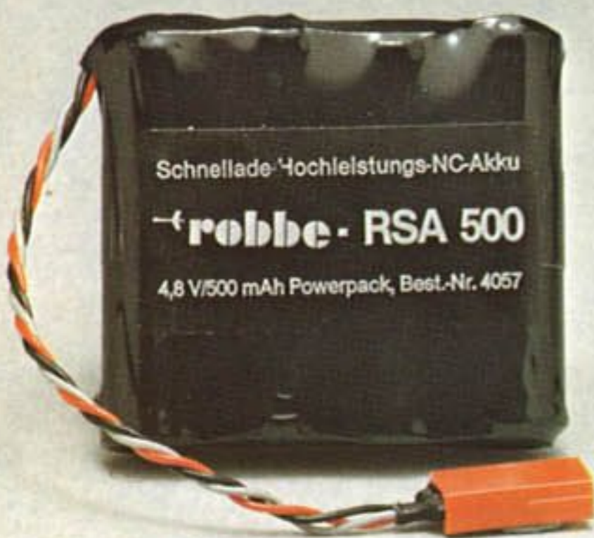
Schnellladefähiger Powerpack 4,8 V/500 mAh Bestell-Nr. 4057 Empfängerakku mit 3-pol-Minibuchse, flache Bauform, besonders für RC-Cars geeignet, schnellladefähig Maße ca. 56 x 52 x 14,5 Gewicht: 94 g
