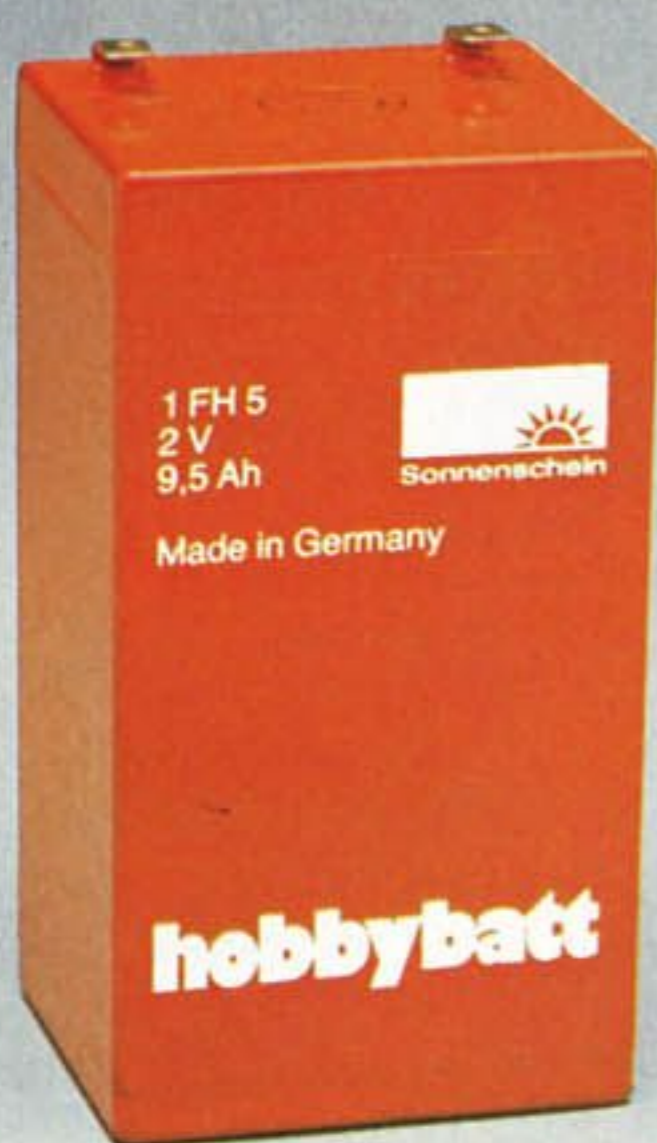
robbe-hobbybatt-Bleiakkumulator Bestell-Nr. 4545 Spannung 2 V, Kapazität 9,5 Ah Abmessungen: 52 x 50 x 94 Gewicht: 575 g
