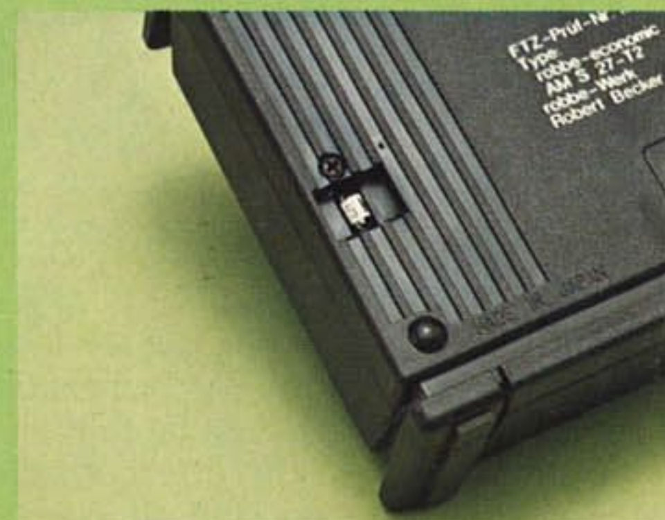
Quarzschieblade an der Senderrückseite
