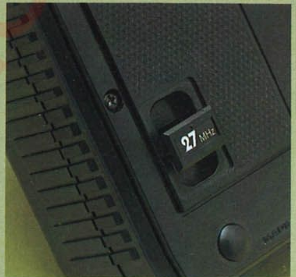
Quarzschieblade auf der Senderrückseite
