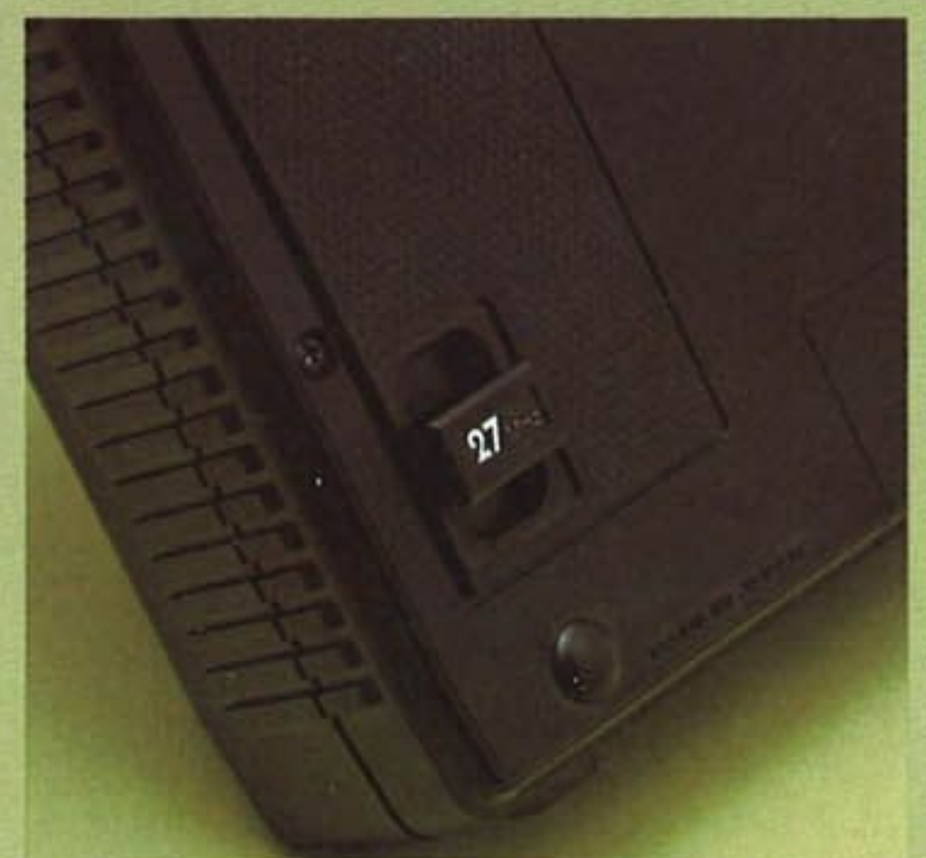
Quarzschublade an der Senderrückseite
