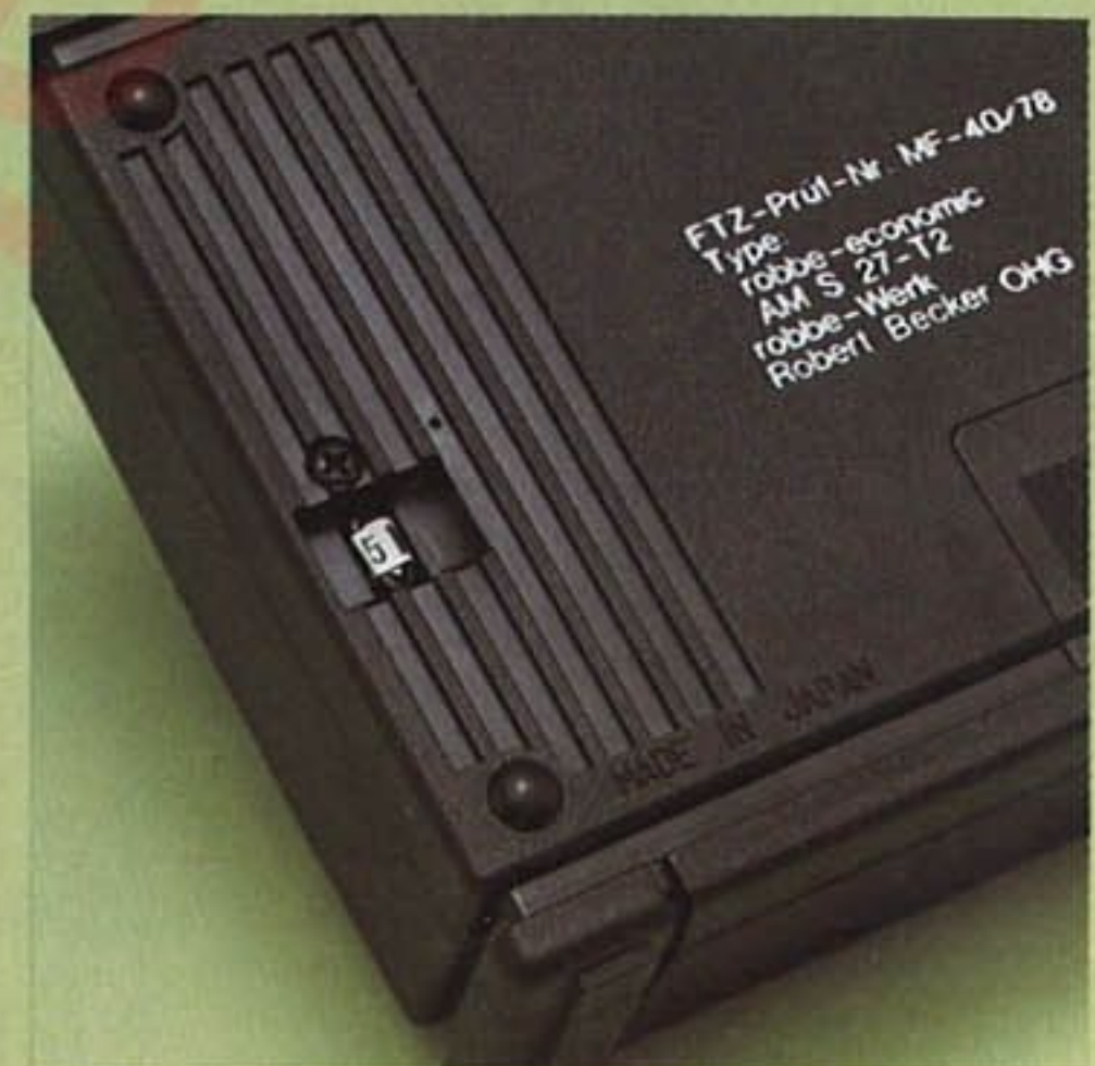
Senderrückseite, Quarz von außen wechselbar
