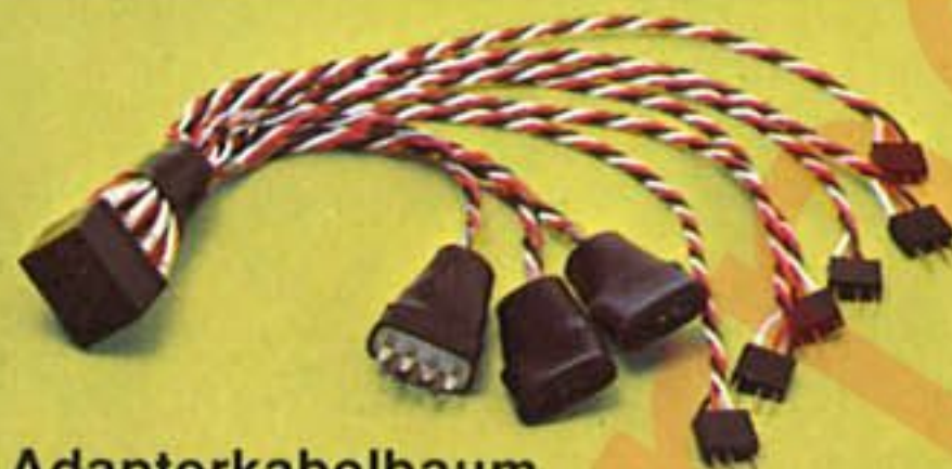
Adapterkabelbaum Bestell-Nr. 8064 zum Anschluß von bis zu 6 Servos FP-S 2 oder FP-S 3 an die Em- pänger-Type FP-R 6 D in Ver- bindung mit dem Schalterkabel Bestell-Nr. 8038 und dem Power- Pack 8032.
