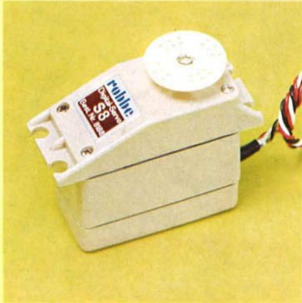
Dieses Servo wurde speziell für Einziehfahrwerke und für Sonderfunktionen entwickelt. Es ist äußerlich gleich mit dem Servo FP-S 7, arbeitet jedoch nicht proportional und ist nicht trimmbar. Bei Betätigung des Steuerknüppels am Sender erfolgt ein Vollausschlag bis zur Endstellung, in der das Servo automatisch abschaltet. Das Servo entwickelt bei einer Laufzeit von 3 Sekunden und einem Ruderweg von 170° einen **Ruderdruck von 8 kg·cm**.
