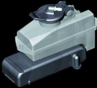
Der Renntank steht in der Fahrzeugmitte und wird über Karosseriesplinte gehalten. Diese neuartige Konstruktion reduziert Vibrationen und ermöglicht eine optimale Ausnutzung des Tankinhaltes.
