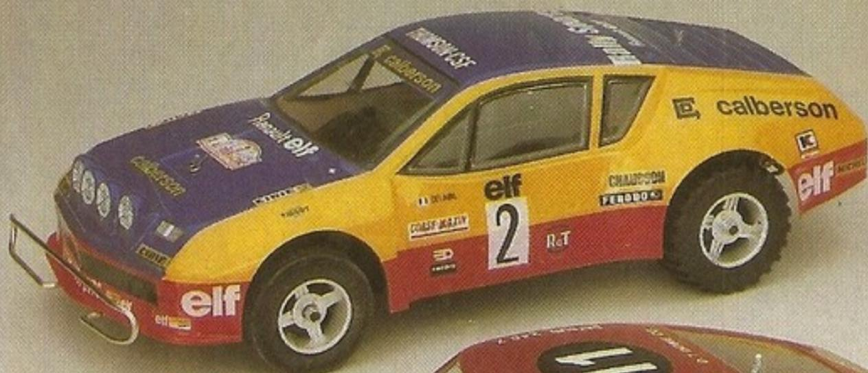
Maquetas prefabricadas particularmente interesantes desde el punto de vista técnico. Para una estabilidad en marcha óptima, suspensión independiente de las ruedas delanteras, eje trasero oscilante de doble articulación con diferencial, brazos oscilantes y resortes helicoidales tales como se utilizan en los autos de carrera profesionales. Motor eléctrico RS 540 montado con gran poder de aceleración, caja de tres marchas. Carrocería de policarbonato no pintada.
