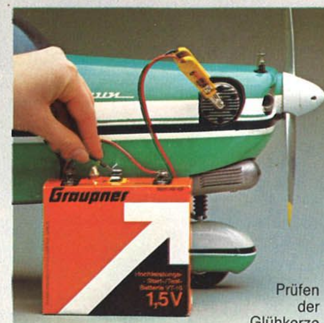
Prüfen der Batterie
